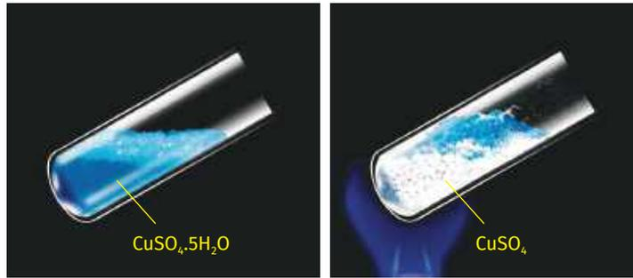
**Gambar 7.2** Pemanasan padatan  $\text{CuSO}_4 \cdot 5\text{H}_2\text{O}$  menghasilkan  $\text{CuSO}_4$
