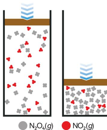
**Gambar 7.7** Pengaruh tekanan pada kesetimbangan  $\text{N}_2\text{O}_4$  dan  $\text{NO}_2$
