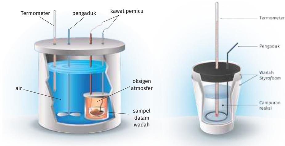
**Gambar 5.3** Kalorimeter bom dan kalorimeter sederhana
