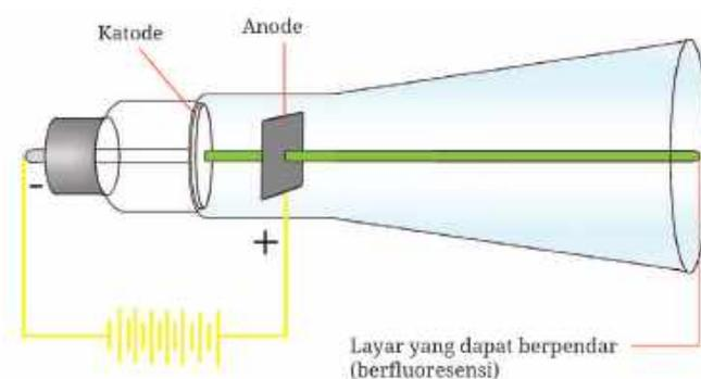
**Gambar 1.3** Tabung katode yang terdapat pada perangkat televisi
